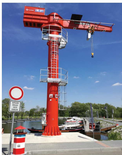
Přístavní sloupový jeřáb 10t
